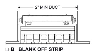
□ **B BLANK OFF STRIP**SHIPPED IN 6"-0" LENGTHS FOR
