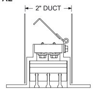
□ 20 AL SINGLE BLADE DAMPER (FRICTION HINGE TYPE)
